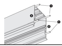
PLEASE NOTE -DO NOT USE JOINT PINS IN THE **SECOND TO LAST LUMINAIRE IN** THE RUN
